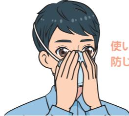
使い捨て式防じんマスクはマスク全体を両手で覆い、息を吐きます。使い捨て式防じんマスクと顔の接触部分から息が漏れてないか確認します。取替え式防じんマスクはフィットチェッカー等を用いて排気口をふさぎます。息を吐いて、空気が面体内から流出せず、面体内の呼気が滞留することによって面体が膨張するかどうかを確認します。
