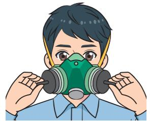
フィットチェッカー等を用いて吸気口をふさぎます。息をゆっくり吸って面体と顔面の間から空気が面体に流入せず、面体が顔面に吸いつけられることを確認します。
